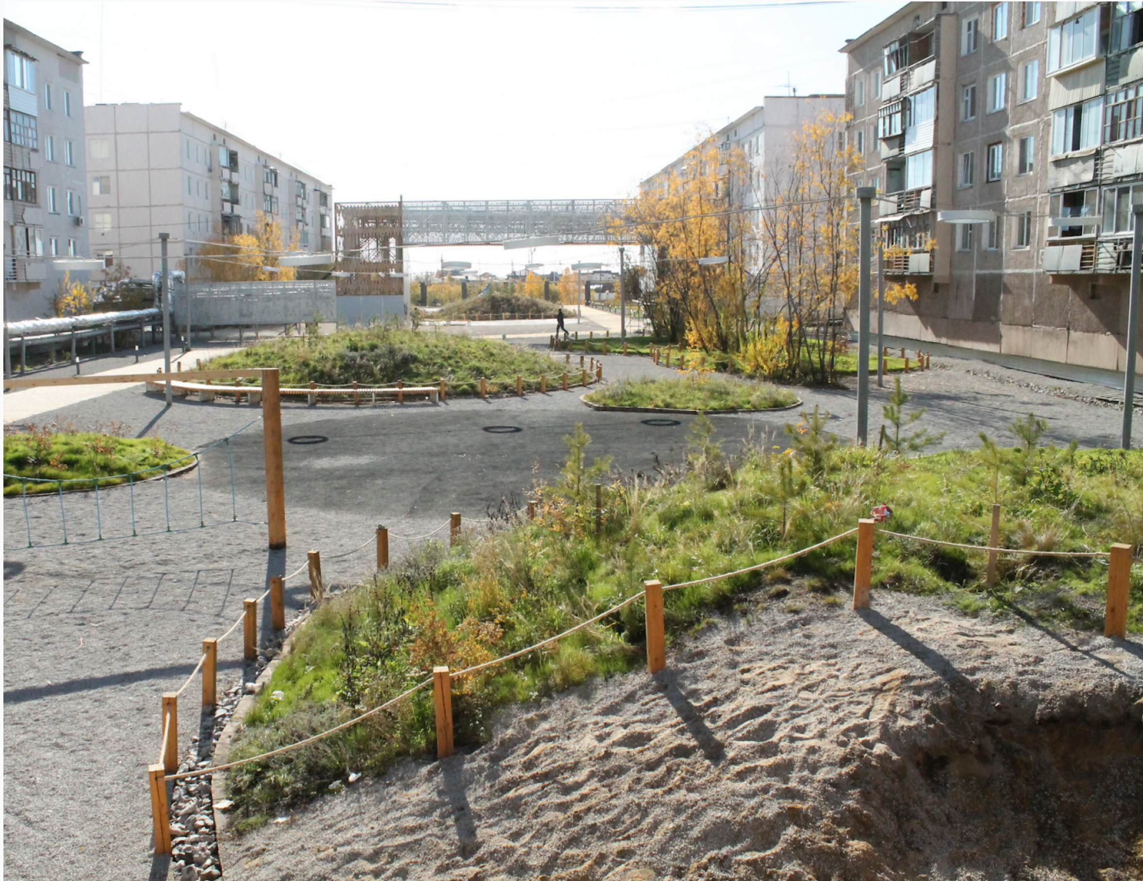
Бульвар учителя в Якутске. Корректировка ветровых потоков с помощью геопластики и посадка растений в условиях вечной мерзлоты
